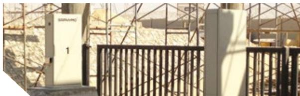
Suivant les normes de qualité les plus strictes, ce nouveau portique permet de contrôler la radioactivité potentielle des véhicules, camions, trains et de leur chargement de façon automatisée. Doté d'un algorithme innovant, le système allie facilité d'utilisation et de maintenance, grande robustesse et avertit l'agent d'exploitation uniquement en cas d'alarme ou de panne.
