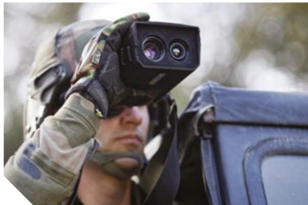
FusionSight® est un monoculaire portable qui fournit en temps réel **3 modes de vision** : visible couleur Bas Niveau de Lumière (BNL), thermique, et fusion BNL et thermique. Adapté aux chefs de groupe d'infanterie et aux forces spéciales, cet **équipement ergonomique** et léger est efficace sur le terrain face à des ennemis dissimulés ou camouflés.
