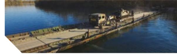
Le PFM est un système de franchissement de brèche humide adapté aux besoins des Forces Terrestres. Robuste et fiable, il peut être déployé comme un **pont flottant continu MLC 80** ou un **ferry roll-on/roll-off**.
