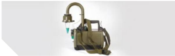
Cet instrument dédié aux équipes NRBC ou primo-intervenants permet une collecte fiable des agents pathogènes en cas de suspicion de menaces biologiques. Robuste, portable et rapidement déployable, il a été développé pour des environnements difficiles et la surveillance de points sensibles. Sa technologie cyclonique lui permet d'être compatible avec toutes les méthodes d'identification.
