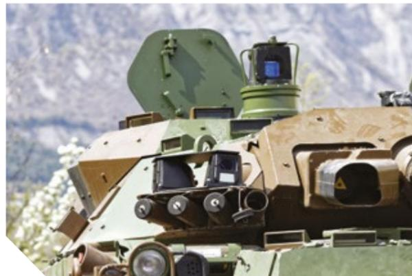
Positionnés en réseau autour du véhicule, les modules de PeriSight® sont composés de **caméras couleur Bas Niveau de Lumière (BNL) et thermique**, offrant des modes de vision multiples. Ce système **compatible avec tout type de véhicules** permet une **surveillance 360° jour / nuit**, afin d'améliorer l'**appréhension des situations de terrain** (LSA).
