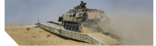
Le PTA est un système de franchissement **modulaire** de brèche sèche : déploiement de 2 ponts MLC 100 de 14 m ou d'un pont long MLC 80 de 26 m.
