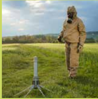
Sondes de surveillance radiologique de l'environnement
