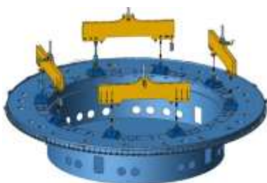
Figure 1: palonnier pour mise en place de la base du cryostat (1250 tonnes)
