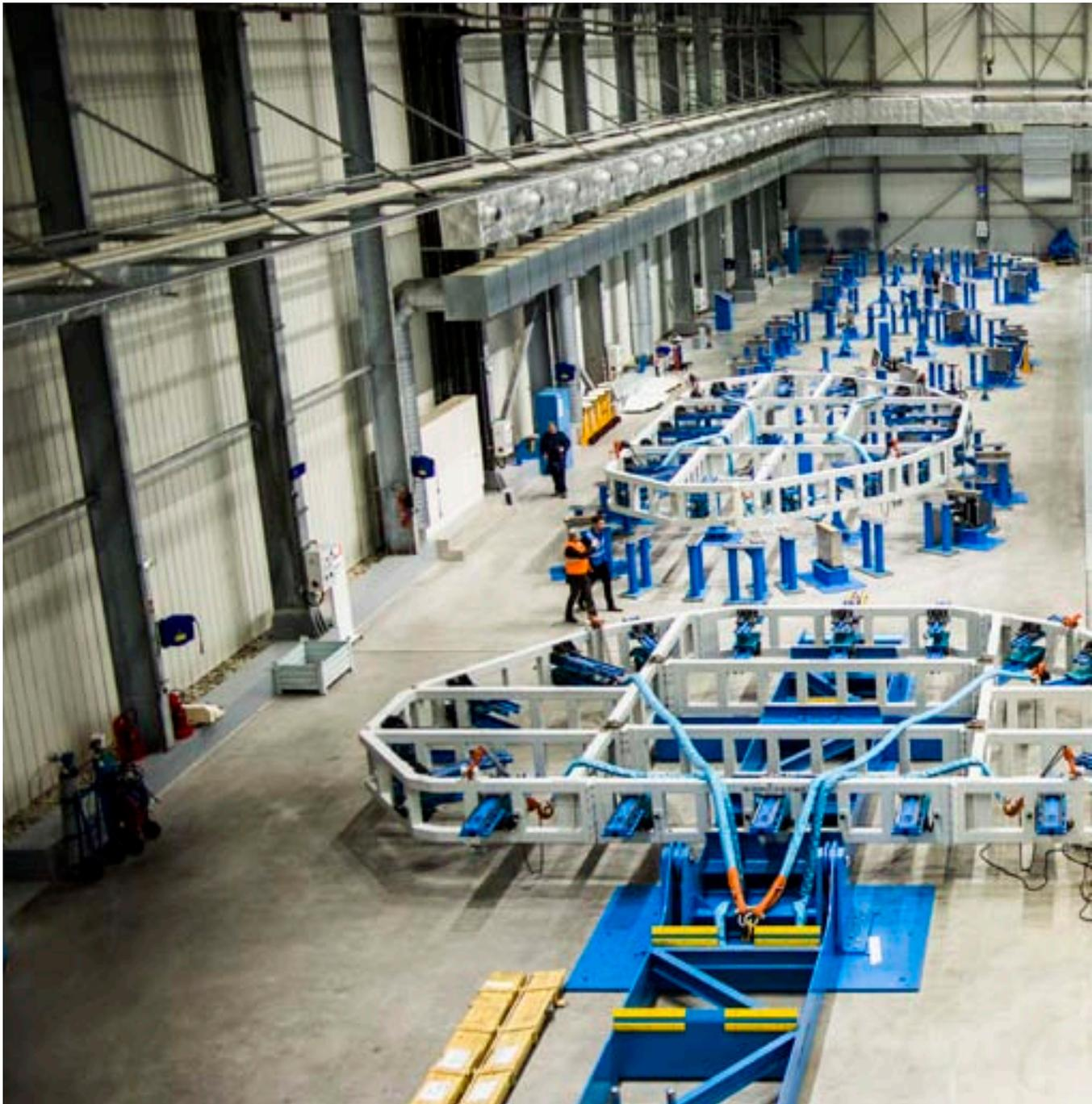
Hall de fabrication des plaques radiales du réacteur ITER, site industriel de CNIM à La Seyne-sur-Mer.
