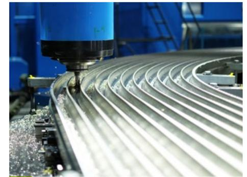
Fabrication série de 35 plaques radiales pour ITER
