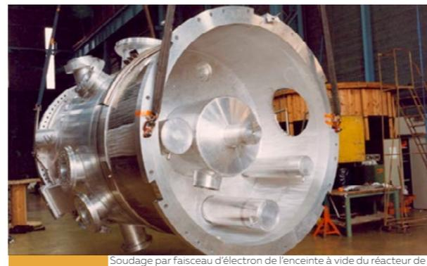
Soudage par faisceau d'électron de l'enceinte à vide du réacteur de la source expérimentale de neutrons Heinz Maier-Leibnitz (FRMI)
